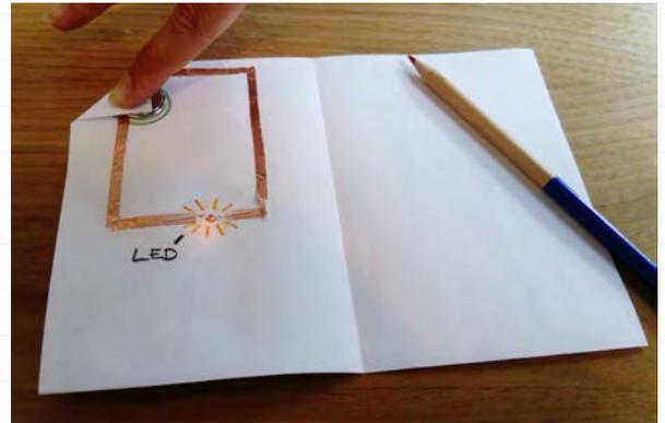
**7** Wird der „Schalter“ jetzt nach unten gedrückt, bzw. die Karte rechts unten oder links oben eingeklappt, trifft das Kupferband auf die Batterie und der Stromkreis schließt sich: Die LED leuchtet!
