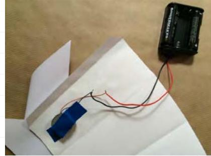
**9** Bevor die Windmühle startklar ist, muss sie noch am schmalen Papiersteifen zusammengeklebt werden. Als allerletzter Schritt werden nun alle Batterien ins **BATTERIEGEHÄUSE** eingelegt. Das Gehäuse kann im Inneren der Mühle versteckt werden. Sobald der Strom beim Motor ankommt, beginnen sich die Flügel der Windmühle zu drehen. Viel Spaß!
