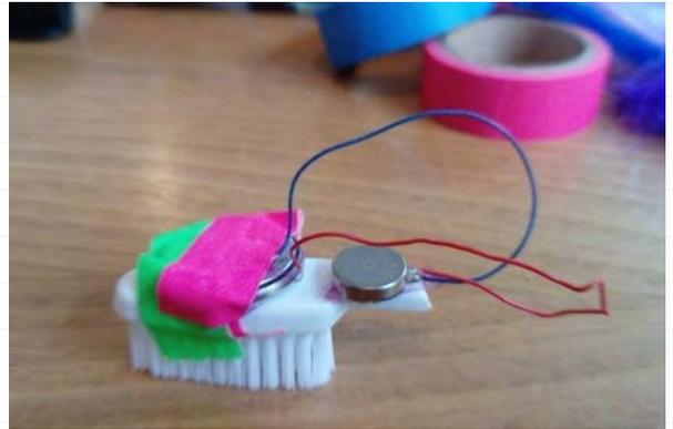
**3** Anschließend wird die Batterie samt **VIBRATIONSMOTOR** mit dem Gaffa-Tape auf dem Kopf der Zahnbürste befestigt. Das lange Beinchen wird dabei auf der Plusseite der Batterie, das kurze Beinchen auf der Minusseite befestigt.
