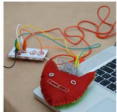
**6** Dann wird das MaKey MaKey mit einem USB Kabel an den Computer angeschlossen. Der Soft Controller kann jetzt für alle möglichen Computerspiele eingesetzt werden. Wie das geht? Ganz einfach: Wenn die leitenden Elemente auf dem Controller berührt werden, wird der Stromkreis geschlossen. Das Spiel kann beginnen!
