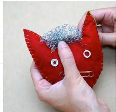
**5** Jetzt werden die leitfähigen Fäden und der Schwamm jeweils mit einer Krokodilklammer mit den Pfeilanschlüssen des MaKey MaKey verbunden. Die schwarze Klemme wird an den „Earth“-Eingang des MaKey MaKeys angeschlossen und in die Hand genommen.
