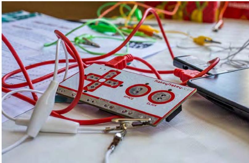
**1** Zunächst wird das MaKey MaKey in Betrieb genommen: Um das Makey Makey mit Strom zu versorgen, wird es mithilfe eines USB-Kabels mit dem Computer verbunden. Die kleinen LED-Lampen auf dem MaKey MaKey beginnen jetzt kurz **GRÜN** zu blinken.
