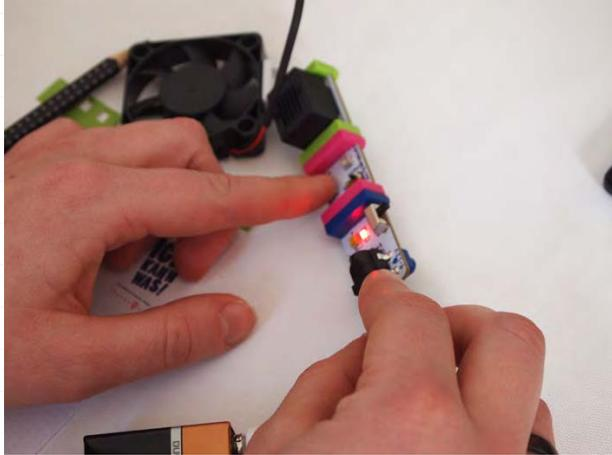
Wenn man sich einen Überblick über den Baukasten mit seinen verschiedenen Modulen und den daraus entstehenden Möglichkeiten verschafft hat, kann es direkt losgehen. Die Module können über Magnete ganz leicht miteinander verbunden, wieder getrennt und neu zusammengesetzt werden. Vielleicht startet man erst einmal mit einem einfachen Stromkreis bestehend aus einer Batterie, dem Power Bit und verschiedenen Input- und Output-Bausteinen.
