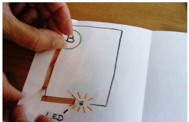
**WICHTIG:** Bitte unbedingt vorher nachsehen, welches Beinchen die Anode und welches die Kathode ist: Das kurze Beinchen (Kathode) entspricht dem Minuspol und muss dort hingeföhren, das lange Beinchen (Anode) entspricht dem Pluspol und muss ebenfalls zu dieser Seite der Batterie föhren.
