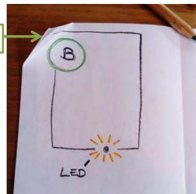
**5** Ist der Stromkreis eingezeichnet, werden die Beinchen der **LED** durch das Loch gesteckt. Das **KUPFERBAND** oder der **LEITENDE LACK** wird auf die zwei eingezeichneten Stromleitungen geklebt, auch die Beinchen der LED werden mit einem Tesafilm fest auf das Kupferband geklebt.
