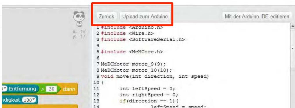
Wenn der Upload beendet ist, kann der Roboter vom Computer getrennt werden, indem das USB Kabel abgezogen wird, und das selbstgeschriebene Programm kann auf freier Fläche getestet werden.
