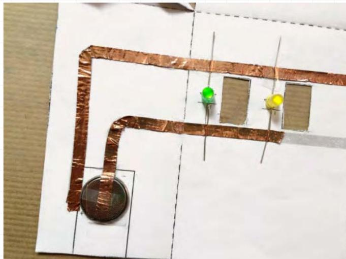
**6** Jetzt können die Kinder die **TÜR DES HÄUSCHENS** aufschneiden. Die LEDs leuchten nicht mehr? Keine Sorge, das ist alles richtig so, denn wird das leitfähige Klebeband durchtrennt, so wird auch der Stromkreislauf durchbrochen. Die LEDs leuchten erst wieder auf, wenn der Kontakt zwischen Batterie und LEDs hergestellt wird, also wenn das Türchen geschlossen wird!
