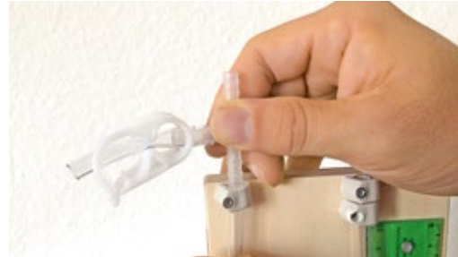
Das T-Kreuz mit dem Schlauchstück und der Klemme auf das U-Rohr-Manometer stecken
