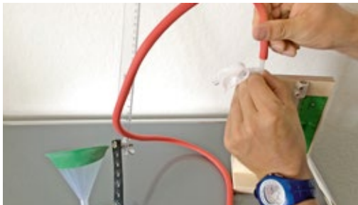
Das andere Ende des roten Schlauchs auf das T-Kreuz stecken
