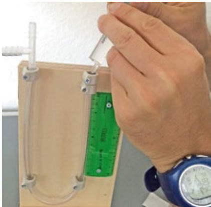
Mit der Spritze Wasser einfüllen, bis der Wasserspiegel auf 0 steht
