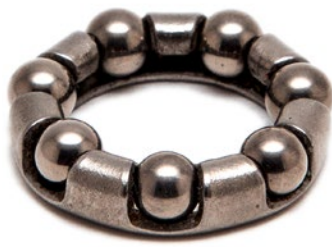
Abb. 11: Das Kugellager am Hinterrad des Fahrrads.
