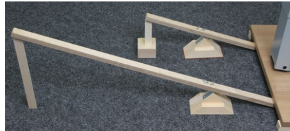
Abb. 27: Die senkrechten „Holzstreifen“ zeigen die Wege der Hand beim kurzen und beim langen Kraftarm.
