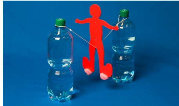
Abb. 8: Mit Knete wird der Schwerpunkt nach unten verlagert.
