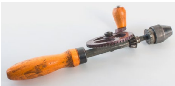
Abb. 28: Die handbetriebene Bohrmaschine mit Übersetzung „ins Schnelle“ (d. h. mit Erhöhung der Drehzahl).
