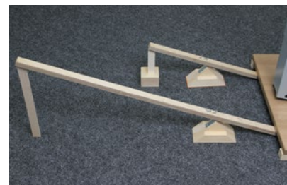
Abb. 23: Der lange Kraftarm legt einen längeren Weg beim Herunterdrücken zurück als der kurze Kraftarm.
