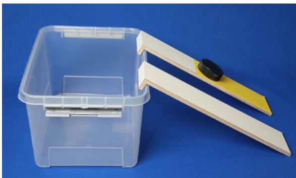
Abb. 12: Ein Puck rutscht auf einer glatten und einer rauen Rampe herunter. Auf der rauen Rampe wird er abgebremst und bleibt liegen, auf der glatten Rampe rutscht er bis unten.
