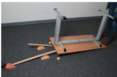
Abb. 21: Aufbau des Versuchs a): ein Kind sichert hinten den Tisch gegen Verrutschen.
