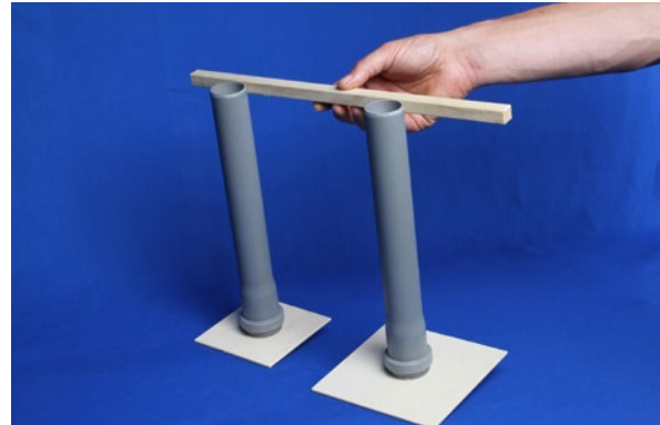
Abb. 2: Zwei Türme auf unterschiedlich großen Standflächen.
