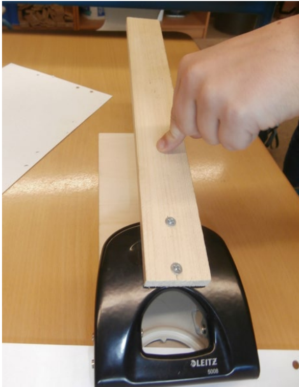
Abb. 25: Die Schülerinnen und Schüler lochen Papier bzw. eine Pappe mit einem Locher, der durch eine Leiste verlängert ist.
