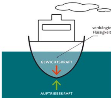
Abb. 6: Die Auftriebskraft hängt vom Volumen der verdrängten Flüssigkeit ab.
