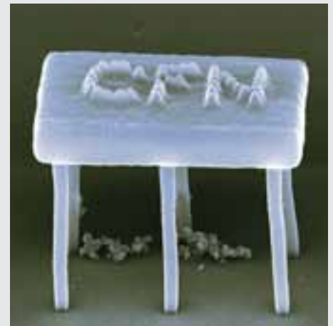
Bauteile und Komponenten im Miniaturformat erzeugen – das ist ein Ziel der Nanotechnologie. Dieses Logo des Centrums für Funktionelle Nanostrukturen (CFN) ist nur unter einem Spezialmikroskop zu erkennen.
